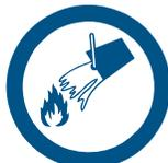
Bei Brand in Verbindung mit Lithium-Ionen-Batterie große anhaltende Wassermenge verwenden.
