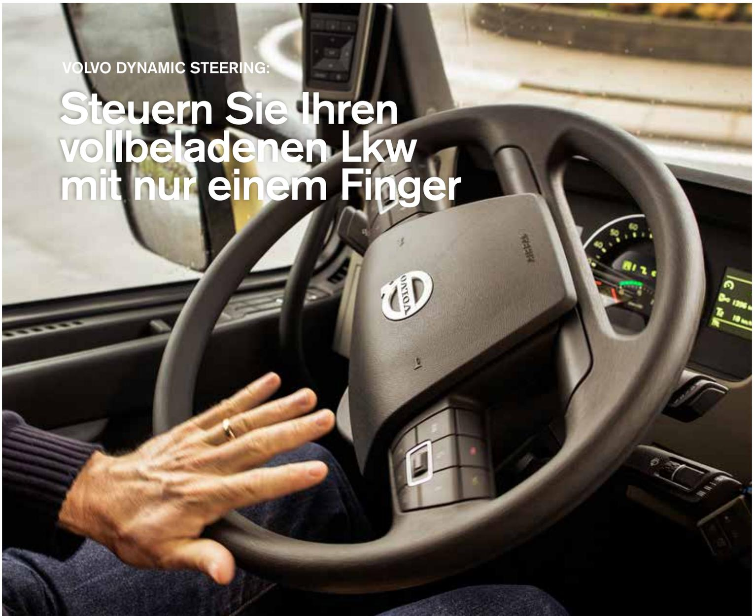
Das revolutionäre Volvo Dynamic Steering kombiniert eine hydraulische Lenkung mit einem Elektromotor. Das Ergebnis: perfekte Lenkkontrolle und deutlich weniger Belastung für den Fahrer.
