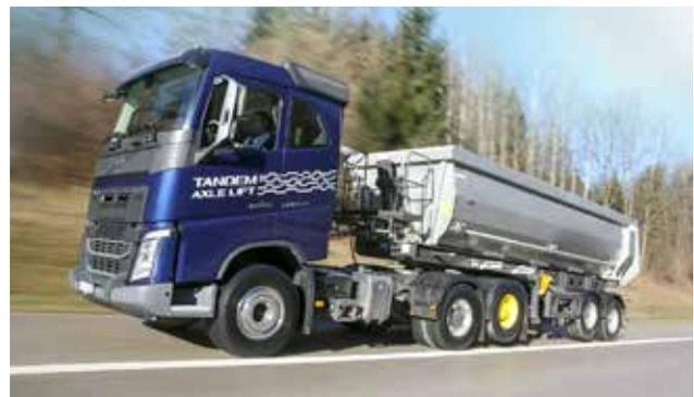
**BESTE FAHREIGENSCHAFTEN.** Der Geräuschpegel im Fahrerhaus ist niedriger und es entstehen weniger Lenkradvibrationen, wenn die Antriebsachse angehoben ist. Dadurch erhöht sich der Komfort bei Leerfahrten.
