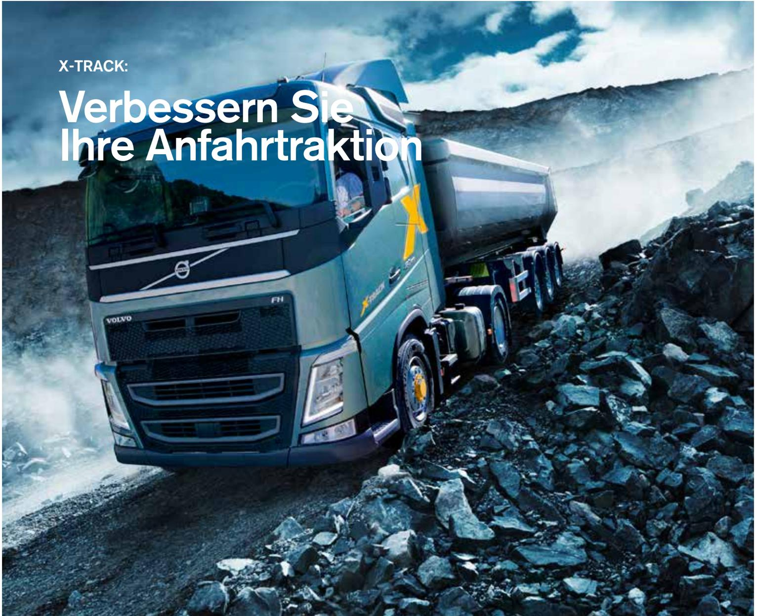
X-Track bietet mehr Anfahrtraktion und Vorderradantrieb bei Geschwindigkeiten von bis zu 20 km/h. Das System besteht aus einem hydraulischen Radantrieb, der an der Vorderachse montiert ist. Dieser sorgt für eine bessere Traktion im Gelände und auf der Straße.
