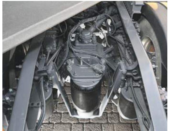
Knickt man den Zug etwas ein, erkennt man gut den Luftbalg, der für das Heben der zweiten Antriebsachse zuständig ist
