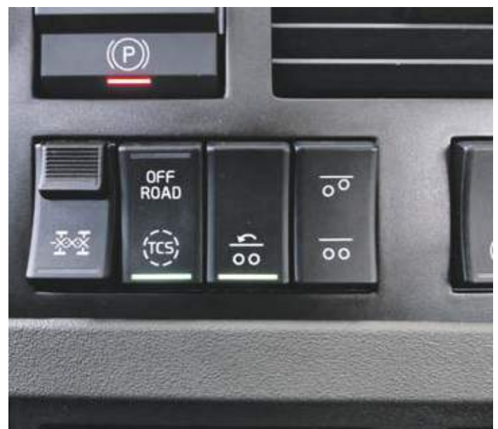
Traktions-Schaltzentrale: Ganz links lassen sich alle Sperren in logischer Reihenfolge durchschalten, „Off Road“ schaltet die Traktionskontrolle ab. Der Schalter mit dem Pfeil entlastet zeitlich begrenzt die letzte Achse, um mehr Aufstandsdruck auf die erste Antriebsachse zu leiten. Der Schalter ganz rechts hebt die Achse manuell, sofern die Gewichtsverhältnisse dies erlauben
