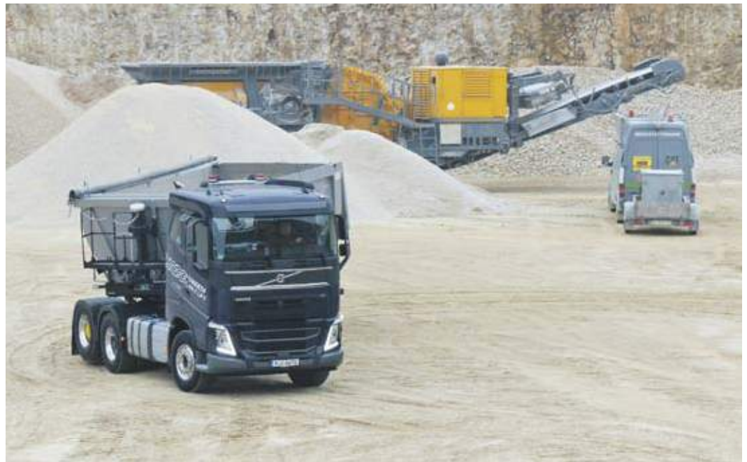
Der Gewinn an Wendigkeit durch die Liftachse bei Leerfahrt ist enorm. Als 4x2 mit einachsiger Kippauflieger lässt sich der Volvo praktisch ohne Reifenverschleiß sozusagen auf dem Teller drehen
