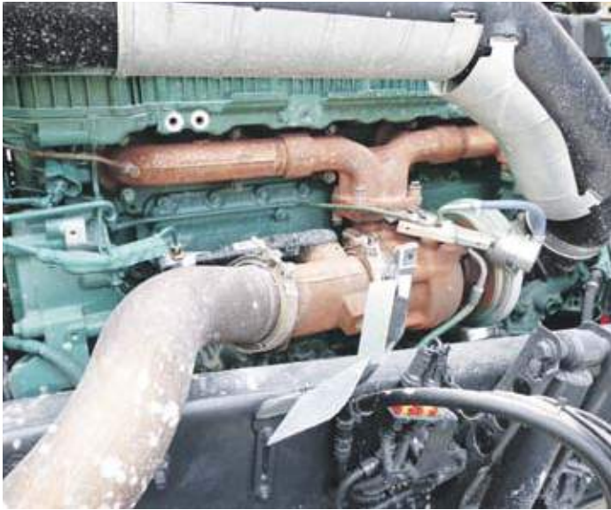
Heiße Seite: kleiner, schnell ansprechender Lader mit Wastegate. Auch hier beste Zugänglichkeit
