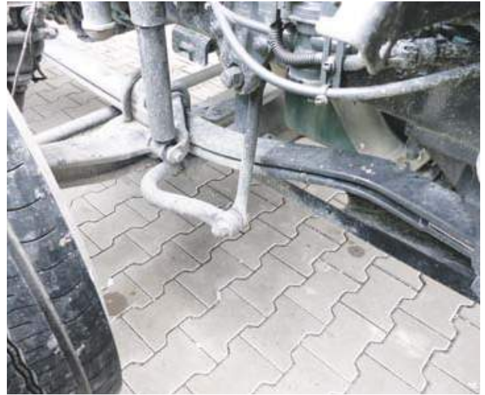
Die gekröpfte Doppelblattfeder vorne ist schon ziemlich steif, deshalb genügt ein relativ dünner Stabi gegen Wankbewegungen
