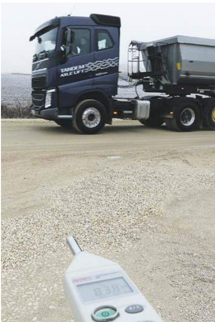
Bei Leerfahrt und mit gelifteter Achse läuft der Kippsattel auf Schlechtweg messbar leiser
