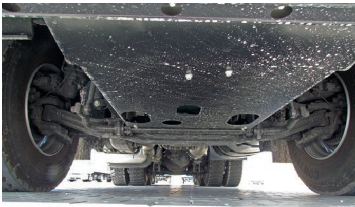
Nur die Ölwanne des 6x4 wird durch eine massive Prallplatte geschützt, beide Fahrzeugkonzepte haben ausreichend Bodenfreiheit
