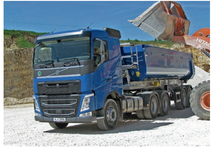
Der „FH 460 4x2“ (linkes Bild) ist ein Leichtgewicht: Nur 7.130 Kilogramm zeigt die Waage. Der weit robuster ausgelegte 6x4 wiegt dagegen fast zehn Tonnen
