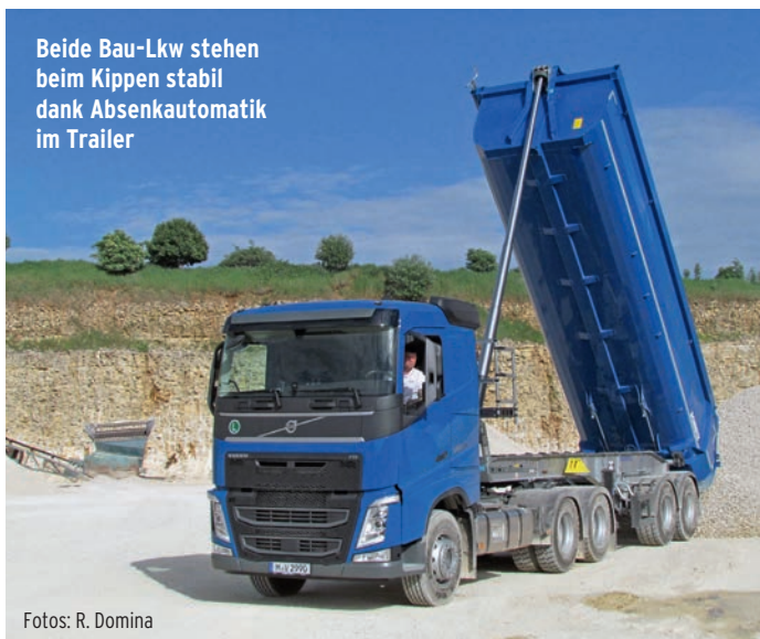
Der „FH 460 4x2“ (linkes Bild) ist ein Leichtgewicht: Nur 7.130 Kilogramm zeigt die Waage. Der weit robuster ausgelegte 6x4 wiegt dagegen fast zehn Tonnen
