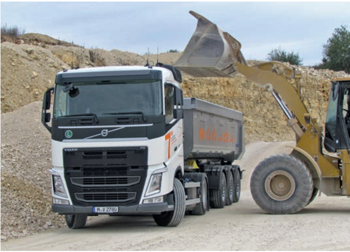
Der „FH 460 4x2“ (linkes Bild) ist ein Leichtgewicht: Nur 7.130 Kilogramm zeigt die Waage. Der weit robuster ausgelegte 6x4 wiegt dagegen fast zehn Tonnen
