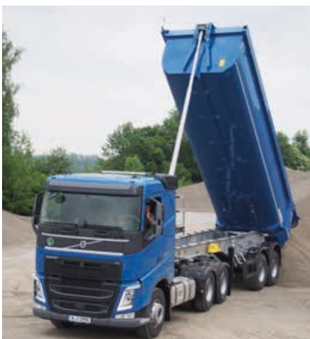
Standstabilität beim Abkippen: Die Aufliegerfederung geht auf Blockstellung.
