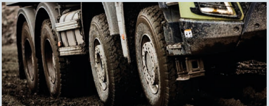
Verlieren die Hinterräder die Haftung, aktiviert eine Klauenkupplung blitzschnell den Vorderradantrieb, die Gefahr des Steckenbleibens ist gebannt.
