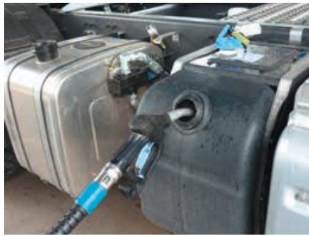
....die rechte Seite mit Hydrauliktank und Adblue-Behälter.
