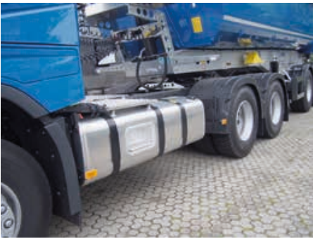
Großer Treibstofftank mit 555 l Volumen auf der linken Seite ...
