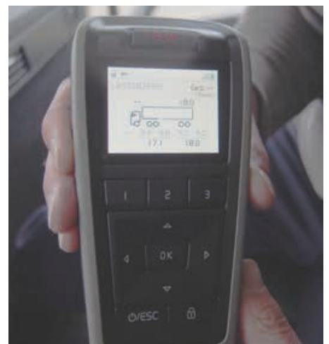
Gewichtskontrolle unterwegs: Die Fernbedienung zeigt auch die realen Achslasten an.
