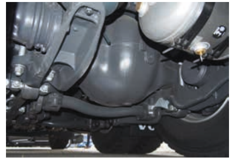
Die Hypoid-Durchtriebsachsen treiben zwar sparsamer an, die große Differenzialglocke reduziert aber die Bodenfreiheit.
