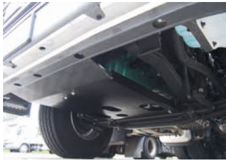
Ein stabiles Blech schützt Kühler und Ölwanne
