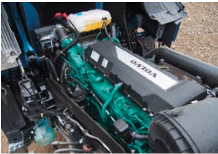
Der Volvo-Sechszylinder D13 erfüllt mit ungekühlter Abgasrückführung und SCR-Abgasnachbehandlung die Euro 6-Emissionsgrenzwerte.
