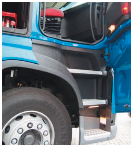
Vierstufiger Aufstieg auf 1,60 m Bodenhöhe – die erste Trittstufe ist latent gefährdet
