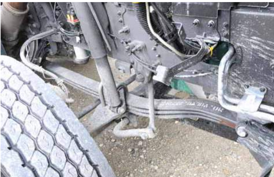
Gutes Ansprechvermögen: Dreiblatt-Parabelfedern der Vorderachsen in markttypischem S-Design
