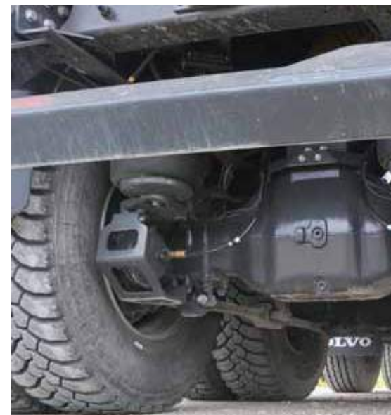
Aufwändig – Achtbalg-Luftfederung für die AP-Tandemachsen und geschützte Bremszylinder
