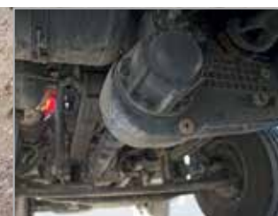
Mit ATC kommt der FMX (l.) fast überall hin, solides Verteilergetriebe an der ersten Achse (kleines Bild)
